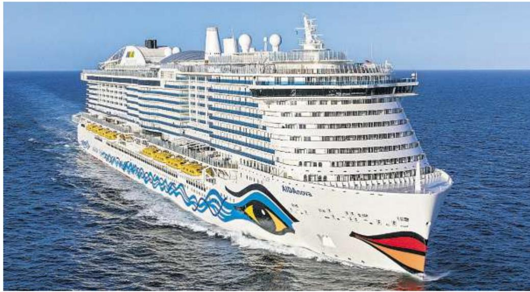
„Green Cruising“: Die im Dezember 2018 erstmals eingesetzte AIDAnova ist das weltweit erste Kreuzfahrtschiff, das vollständig mit emissionsarmen Flüssigerdgas betrieben wird. Foto: AIDA Cruises
