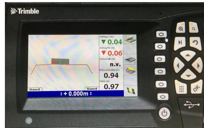
Abbildung: Position des Baggerkübels zum Abtragshorizont
